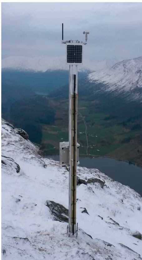
Installerte systemer med værstasjon. Loggeren plasseres enten i et skap på stang eller i en kasse på bakken.
